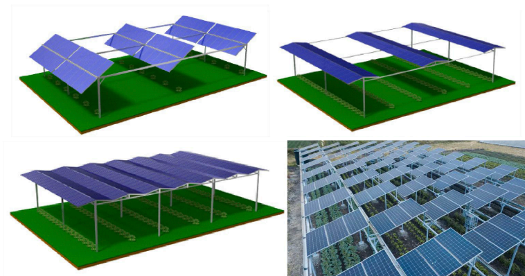
Schéma 2 : Plusieurs modèles et concepts d'installations photovoltaïques surélevées.
